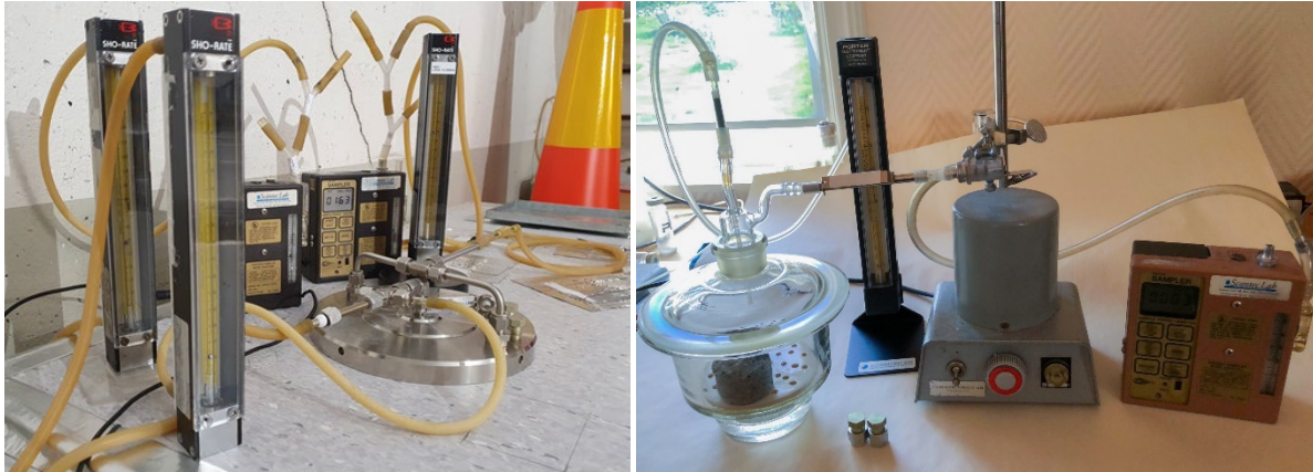
Figur 3. Mätning av emissioner: vänster - ovanpå ett ytskikt med FLEC (foto: Polygon | AK), höger – kammarmätning (foto: Jan Kristensson).
