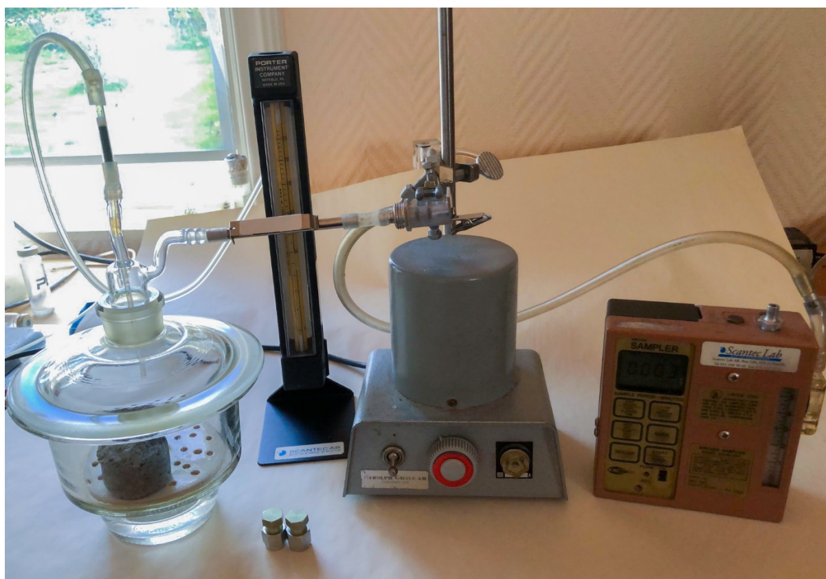
Figur 2. Mätuppställning för kammarmätning. Foto: J. Kristensson.
