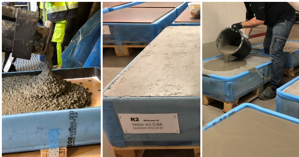
Figur 1. Tillverkning av provkroppar till undersökningen: gjutning (vänster), lagring inkl. själv- eller diffusionsuttorkning (mitten) samt avjämnning (höger).
