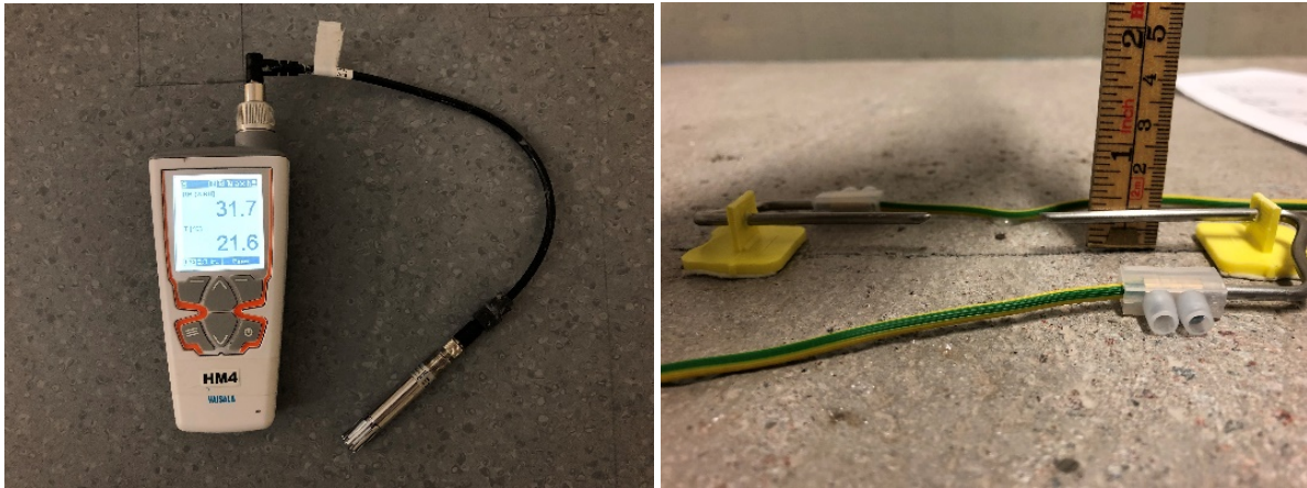
Figur 2. Givare för avläsning av fuktnivå, Vaisala HMP40S för RF i betong (vänster) samt resistiv givare som gjöts in i avjämningen för fuktnivåindikation (höger).
